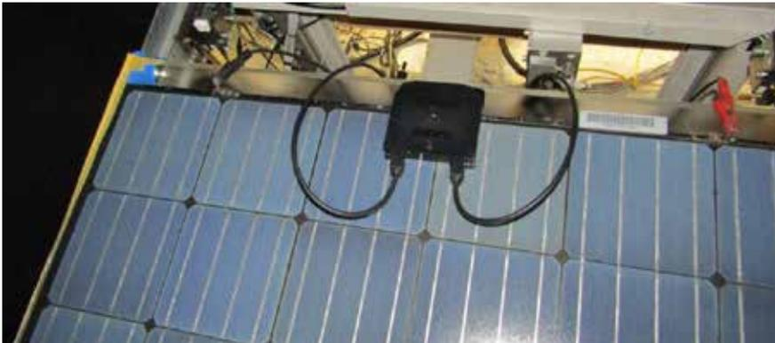
**Abb. 9: Bauweisen mit einer verschattenden Anschlussdose reduziert Bifazialität um 25 %**
