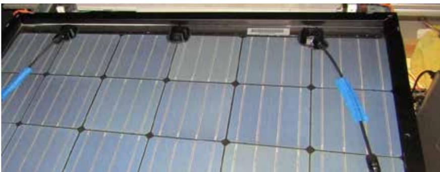
**Abb. 11: Bauweise mit drei verschattenden Anschlussdosen & Rahmen reduzieren Bifazialität um 18 %**
