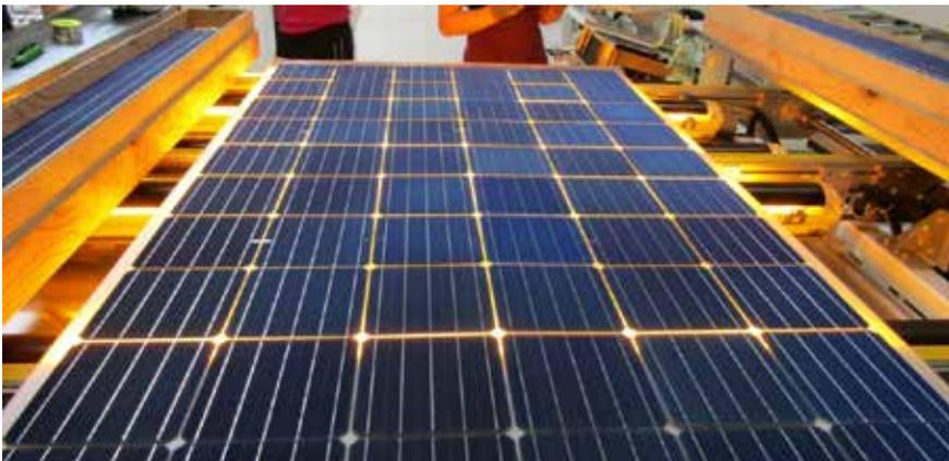
**Abb. 8: Bau der bifazialen 60-Zell-Module in der Fertigungslinie**
